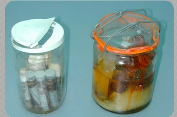
Verduurde en beschadigde dichtingen. Foto: Luc Arens
