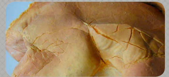
Verduurd rubber. Foto: Luc Arens
