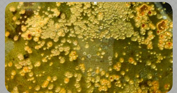
Putcorrosie. Foto: Kenneth Van Maele.
