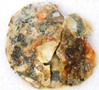
Aangetast silica netwerk. Foto: Natalie Cleeren.
