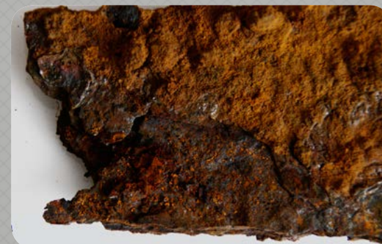
Actieve corrosie op archeologisch ijzer. Foto: Natalie Cleeren.
