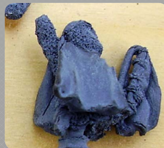
Tinnen figuurtje getroffen door tinpest. Foto: Miniatures forum.
