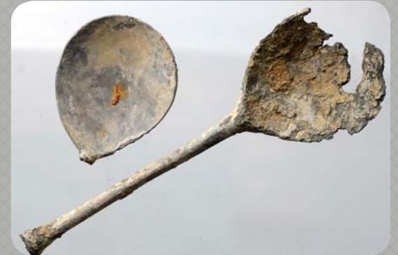
Lepels in lood en tin; tinpest. Foto: Natalie Cleeren.
