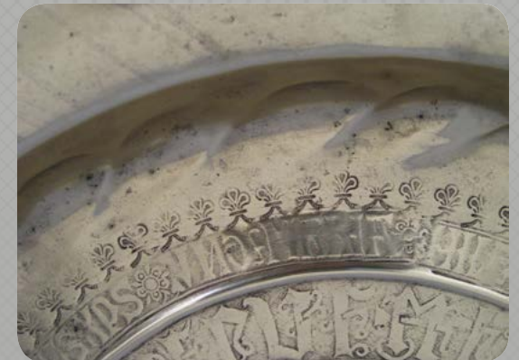
Zilverlaag op messing: corrosie in beschadigde oppervlaktelaag. Foto: Derek Biront.
