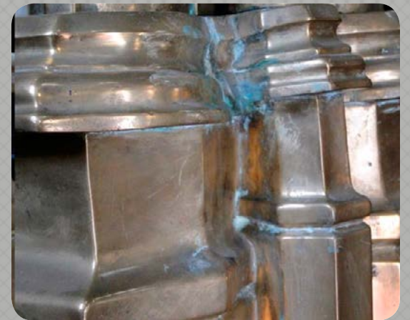
Voet van gotische geelkoperen paaskandelaar: resten van poetsmiddel veroorzaken corrosie. Foto: Leon Smets.
