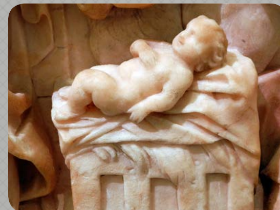
Erosie van albast door nat reinigen. Foto Leon Smets.
